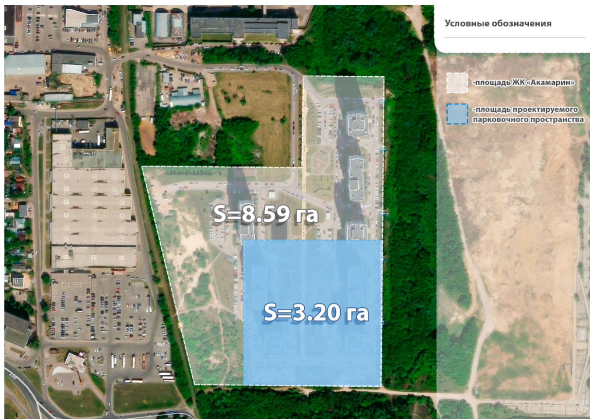
Рис. 4 - Площадь парковки рассчитанной по уровню автомобилизации относительно площади ЖК «Аквамарин». [Спутниковый снимок территории получен с помощью сервиса Google Earth, дата съемки: 16.06.2023 – 21.05.2025]
