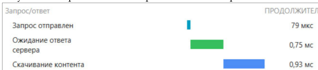
Рисунок 5 – Скриншот времени отклика сервера Apache Полная загрузка каталога 76 мс, с сервера загружено 14,9 кБ данных, время отклика составило 0,75 мс.
