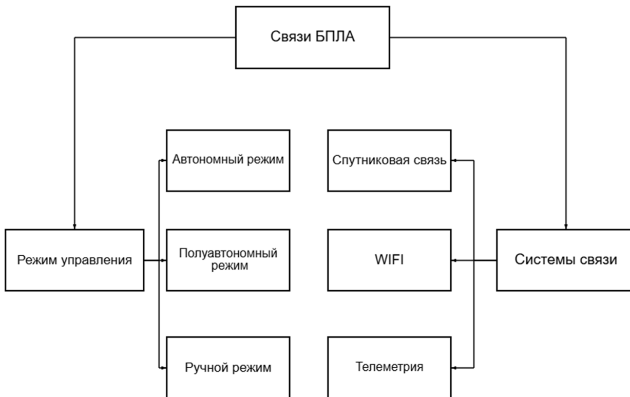
Рисунок 4. Классификация БПЛА по способу управления и типам связи (разработано авторами)
