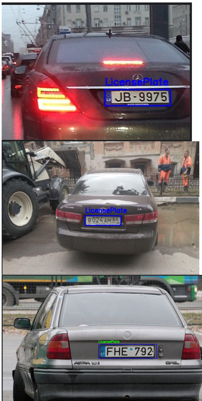
Рисунки 12–14. Результат работы системы распознавания номерных знаков [14, 15, 16] (обработка выполнена авторами)
