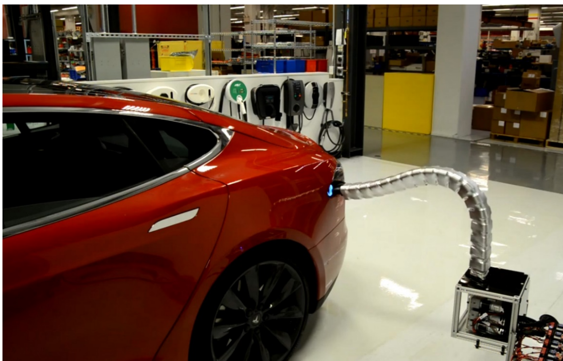
Рисунок 3. Зарядный робот Tesla [6]
