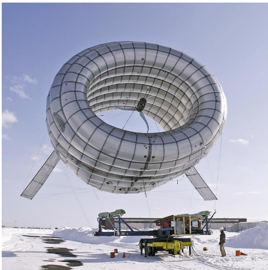
Рисунок 2. Плавающая воздушная турбина (ВАТ)
