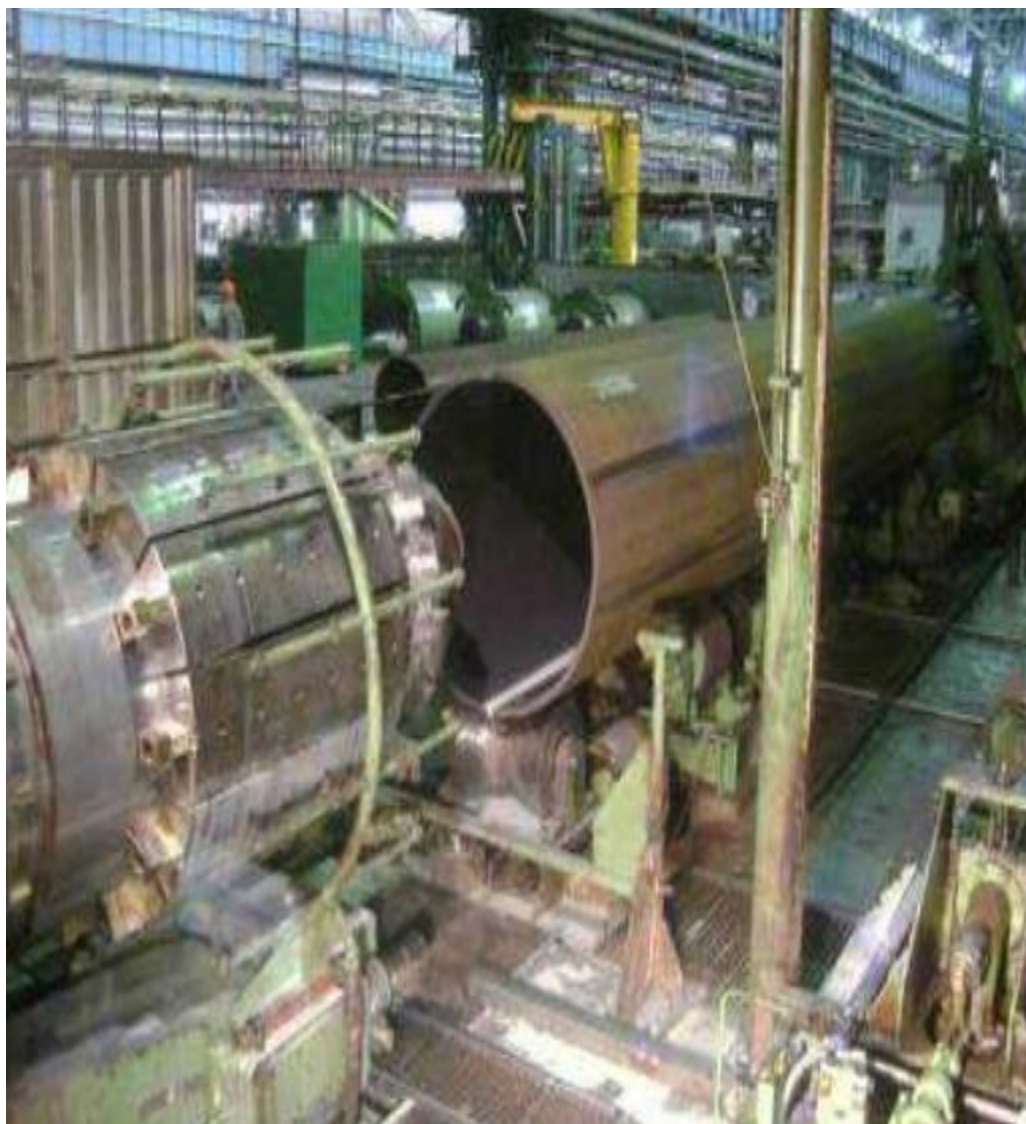
Рис. 1. - Положение экспандера перед его вводом в трубу
