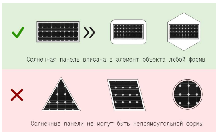
Рисунок 4. Возможный и невозможный варианты работы с формой солнечных панелей
