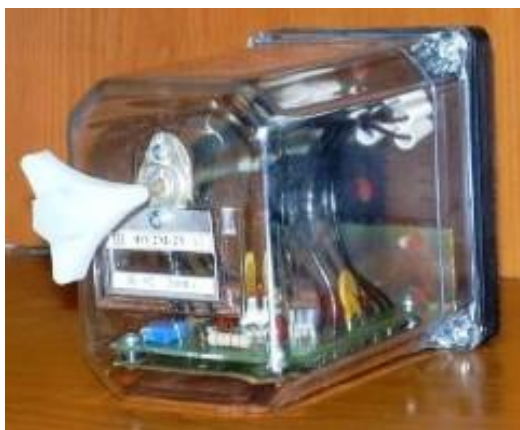
Рисунок 1. Фазирующее устройство ФУ 2, выполненное в корпусе реле НМШ
