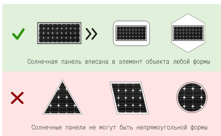
Рисунок 3. Возможный и невозможный варианты работы с формой солнечных панелей
