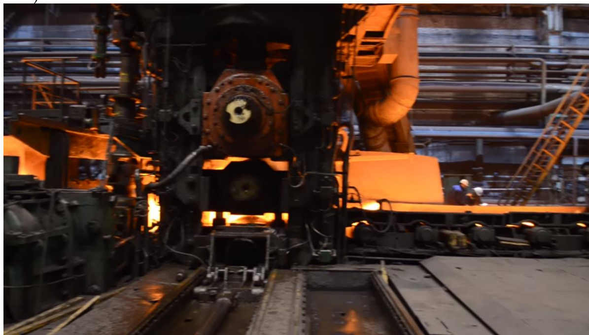
Рисунок 2. Пластическая деформация металла между рабочими валками
