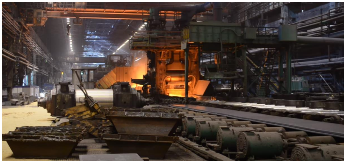
Рисунок 1. Многоклетевой прокатный стан 2000 НЛМК
