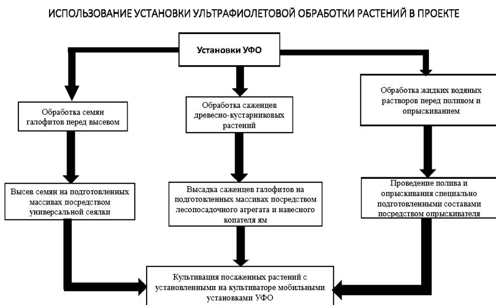
Рис 3. Схема использования установки ультрафиолетовой обработки растений
