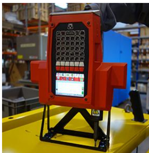
Рисунок 5 – Нанесение QR-кода маркиратором
