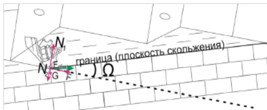
Рис. 3. - Схема действующих сил при прохождении расширителем границы пород из мягких в твердые
