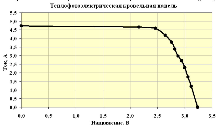
Рисунок 6. Вольтамперная характеристика стационарного теплофотоэлектрического модуля в виде кровельной панели
