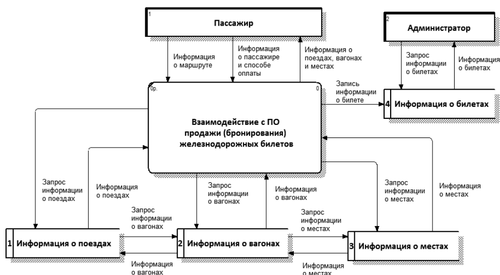
Рисунок 2. Диаграмма потоков данных при взаимодействии с ПО продажи (бронирования) железнодорожных билетов
