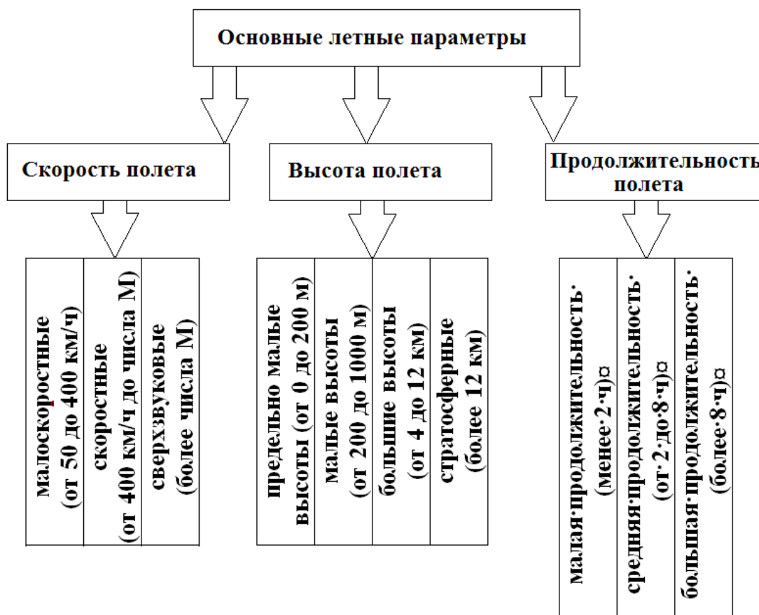
Рисунок 2. Классификация БПЛА по основным летным параметрам, принятая в ВС РФ
