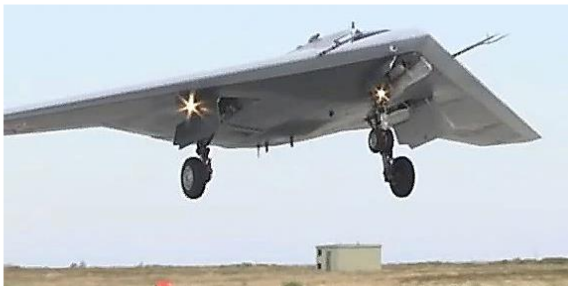
Рисунок 3. Российский тяжелый ударно-разведывательный БПЛА С-70 «Охотник», разработанный авиационным холдингом «Компания Сухой» (URL: https://topwar.ru/167387-novejshij-rossijskij-bpla-ohotnik-dlja-chego-sozdan-i-pochemu-ego-ispugalis-v-ssha.html .)
