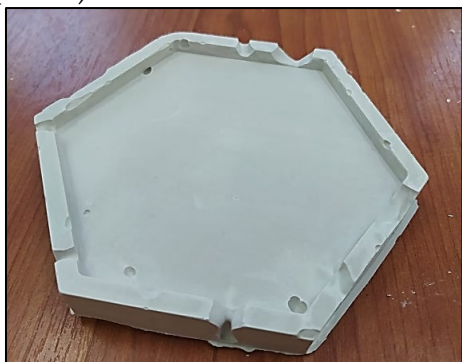
Рисунок 1 – Некачественная поверхность гипсовых изделий
