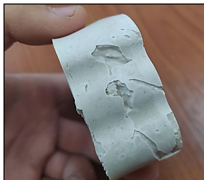
Рисунок 1 – Некачественная поверхность гипсовых изделий
