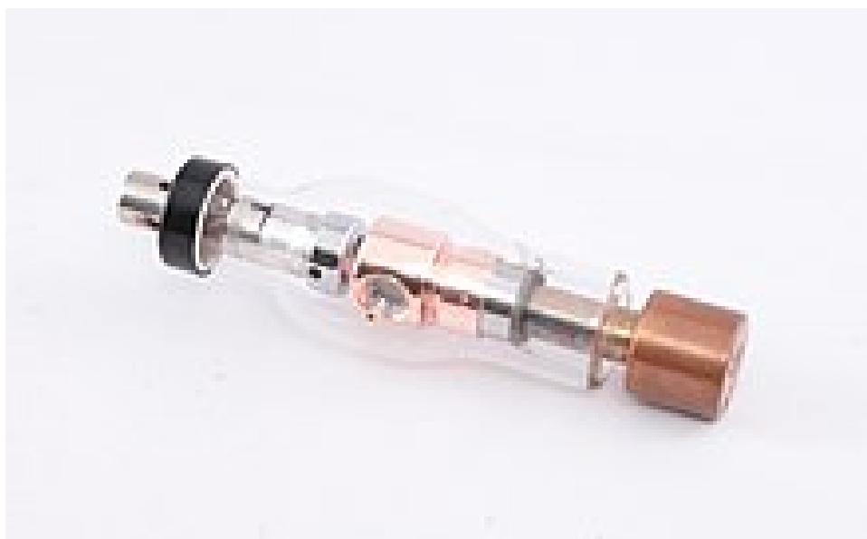
Рисунок 1. – Внешний вид рентгеновской трубки типа ЗБДМ2-100. Произведена заводом «Светлана» в СССР в 1979 году [7].
