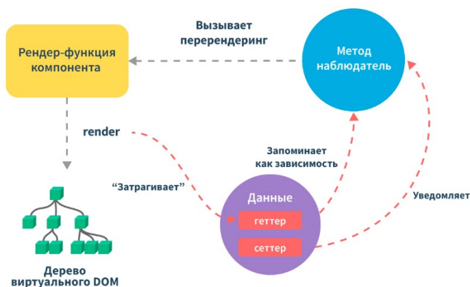
Рисунок 3. Схема обеспечения реактивности Vue 2
