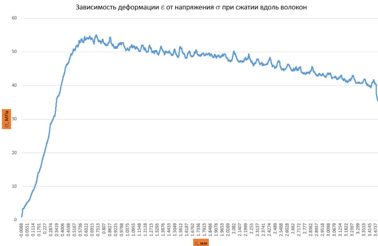
Рисунок 2 – Диаграмма «деформации-напряжения» при испытании на сжатие деревянной прямоугольной призмы №7 размерами 20 × 20 × 30 см
