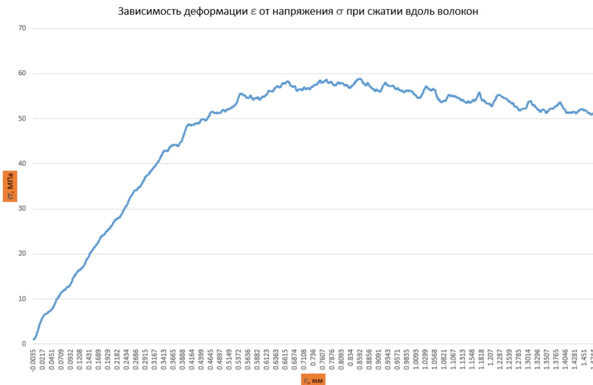
Рисунок 2 – Диаграмма «деформации-напряжения» при испытании на сжатие деревянной прямоугольной призмы №7 размерами 20 × 20 × 30 см
