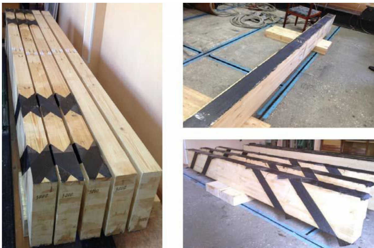
Рисунок 3 – Внешнее армирование несущих деревянных конструкций композитной лентой
